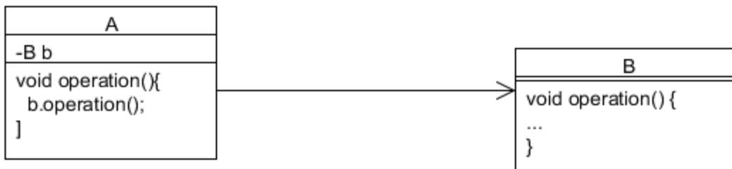
Au lieu que A réalise le code de **operation()**, il délègue à un autre objet **B** de réaliser le traitement.
