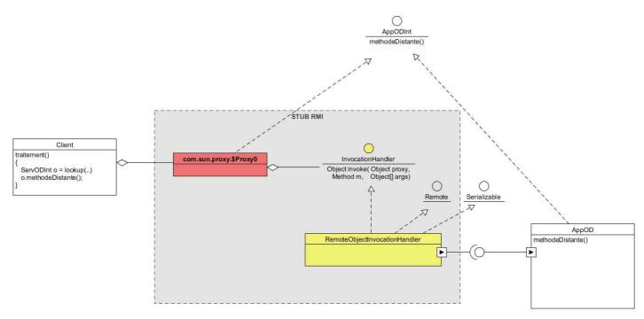
Ce diagramme UML est le diagramme de conception d'un stub RMI qui utilise le DP DynamicProxy.
