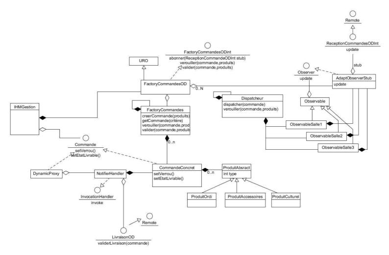
Les commandes sont gérées dans un factory (FactoryCommandes) composé de commandes. Chaque commande (CommandeConcret) est composée des produits (1 sous-classe par héritage que de type de produit). Les commandes sont vues par une interface par le client (principe du DP factory et ce qui permettra de mettre en place un Dynamic Proxy).
