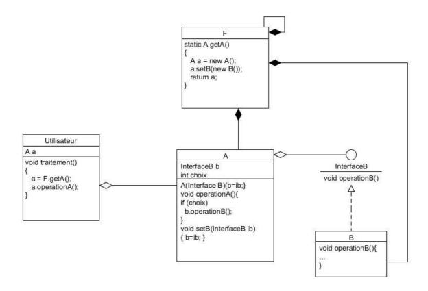
Le rôle de ce DP est d'injecter une dépendance entre deux classes. Ici, F (ex: Framework) fait l'injection de B dans A en utilisant un setteur de A. Ce setteur accepte en paramètre toute classe qui implémente l'interface InterfaceB. L'utilisateur délègue à F le soin de réaliser cette injection. Il ne connait pas ainsi la classe B.
