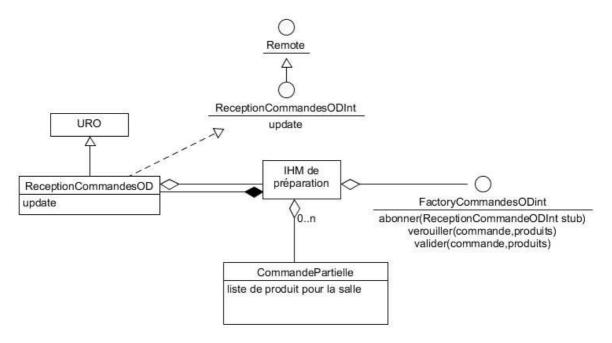
L'IHM de préparation utilise l'interface distante du factory des commandes du composant 1 pour s'abonner en lui passant le stub de ReceptionCommandeOD. Elle utilise cette interface distante pour verrouiller une commande et pour valider la préparation partielle d'une commande.
