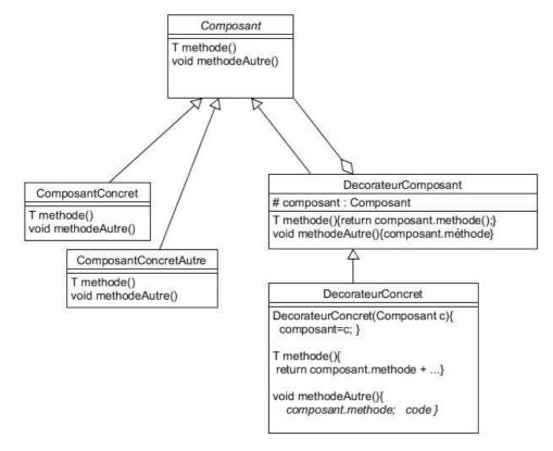
Le rôle de ce DP est de surcharger (étendre ou remplacer) les méthodes d'une classe **Composant** sans utiliser le mécanisme de surcharge (ou redéfinition) de l'héritage qui a ses limites.
