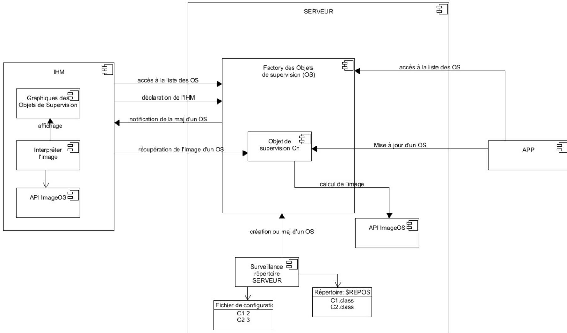
Le sous-composant du SERVEUR, "Surveillance répertoire SERVEUR", s'exécute en tâche de fond. Dès qu'un fichier Cn.class est déposé dans le répertoire \$REPOS, ce sous composant demande au "Factory des Objets de supervision" de créer de nouveaux objets de supervision ou de remplacer ceux qui existent déjà.
